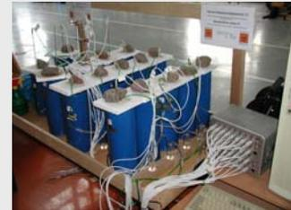
Abb. 2: Kompostierungsanlage mit 2-L-Gefäßen
