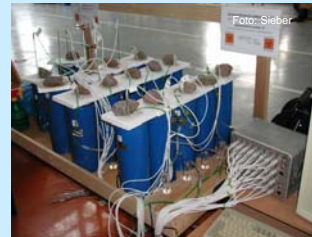
Abb. 4: Dewar-Gefäße mit Sauerstoffzufuhr und Temperaturfühlern
