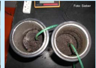
Abb. 5: Dewar-Gefäße mit volumenreduziertem Inhalt nach der Kompostierung
